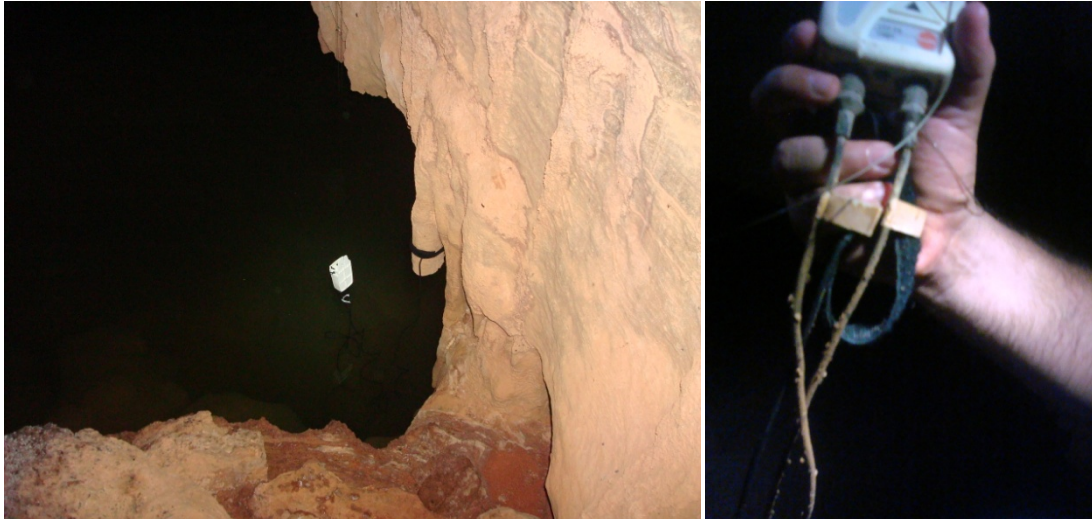
Figura 4: Local de instalação de termômetro com datalogger (esquerda), com sonda de imersão na água e sonda tipo braçadeira, em um espeleotema na parede; e instrumento retirado em outubro/2011 de campo, com sinais de submersão e incrustação carbonática nos cabos das sondas e caixa de proteção (direita).
