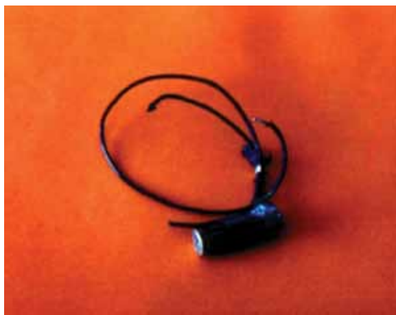
Figura 30 - Rádio-collar danificado pelas maracanãs.
