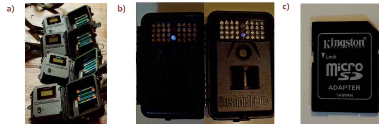
Figura 4.1. Preparação do equipamento. a) Armadilhas fotográficas separadas para conferência e configuração prévia; b) Luz frontal da armadilha mostrando configuração normal (azul) e com algum problema (lilás); c) Cartão de memória não bloqueado para gravação.
