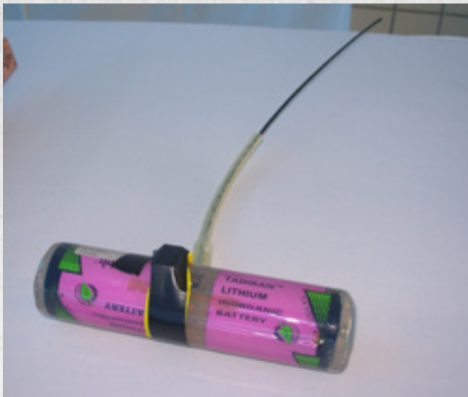
Figura 76. Modelo de transmissor utilizado para monitorar peixe-boi-amazônico e ferramentas para confecção de cintos que serão acoplados na nadadeira caudal. Foto: Fábila Luna (ICMBio/CMA).
