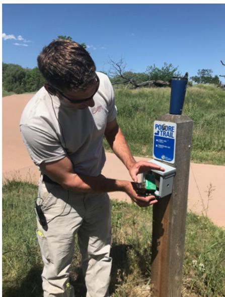
Figura 3 - Exemplo de contador de trilhas utilizado pelo USFS. Discretamente, um contador infravermelho no Parque Estadual Lory (Estados Unidos). Fonte: Autores
