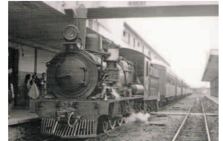
A Pacific 4-6-2 327 da Leopoldina (Beyer Peacock 65909, de 1928) (Fotografia: João Bosco Setti – A Formação das Estradas de Ferro no Rio de Janeiro)
