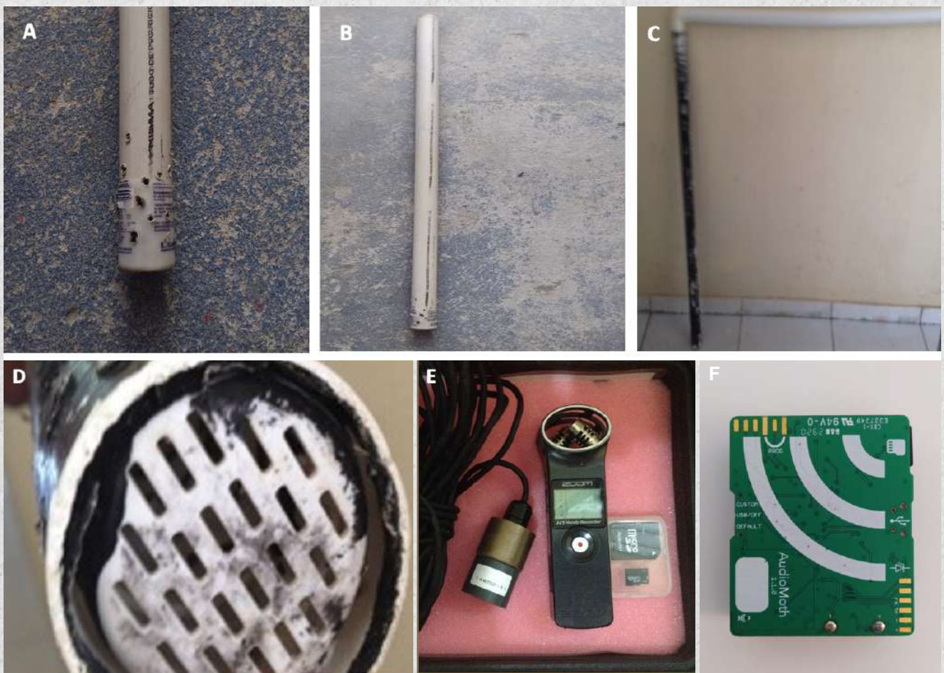
Figura 7. Exemplo de equipamento de gravação subaquático. A - D) Detalhes do cano de PVC com furos para posicionamento do hidrofone em seu interior; Medida de comprimento dos canos em B e C: 1 m. E) Hidrofone modelo SQ26-H1, conectado a um gravador Zoom H1; F) AudioMoth (Fotos: Rebecca Umeed)
