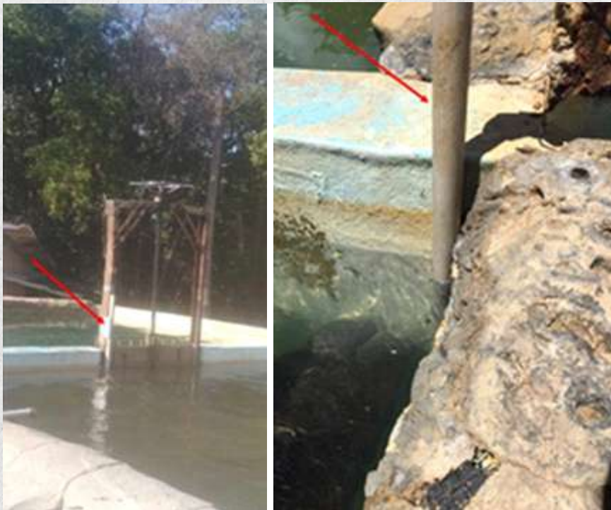
Figura 8. Posicionamento do cano com hidrofone para proteção do equipamento (Fotos: Paula Coutinho).
