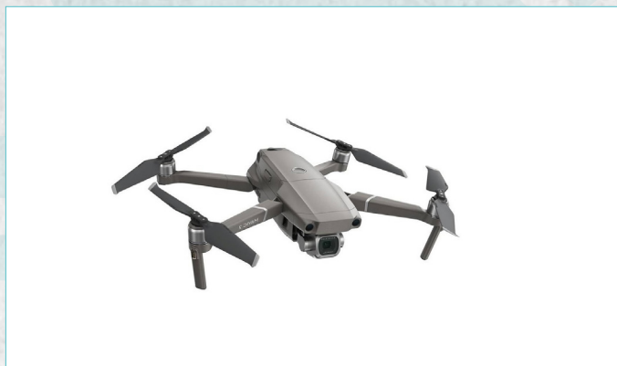
Figura 1. Aeronaves Phantom 4 Pro e Mavic 2 Pro/Zoom. Ambas necessitam apenas do encaixe das hélices (e abertura dos braços no Mavic) para estarem prontas para voo ( Plug and Play ). Resistência ao vento de 36km/h e 38km/h, respectivamente. Fonte: DJI, 2020.
