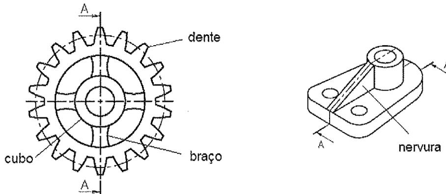
De acordo com a norma ABNT NBR 10067, assinale a opção que apresenta todos os elementos dessa figura que NÃO devem ser hachurados no corte AA.
