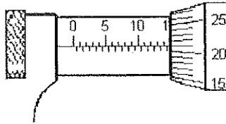
A figura acima representa a escala de leitura de um micrômetro utilizado para levantamento dimensional de peças, graduado em milímetros e meios milímetros, podendo medir até 25 mm, e com aproximação de medidas de 1/100mm (1 centésimo de milímetro).
