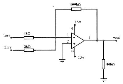
Qual é a tensão de saída (vout) do circuito da figura acima?
