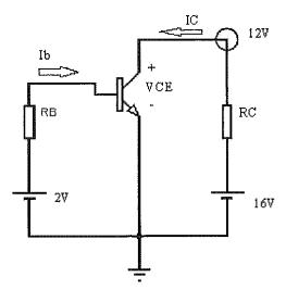
Qual é o valor dos resistores RB e RC, respectivamente, representados na figura acima, para polarizar o transistor com as seguintes características:
