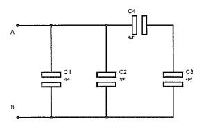
Calcule a capacitância total entre os pontos A e B da rede capacitiva representada acima, e assinale a opção correta.
