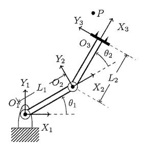
Na figura acima, está ilustrado um robô manipulador com 2 elos (links) com juntas rotativas no plano 2D, além da garra (endeffector).  $L_1$  e  $L_2$  são os comprimentos dos elos. Estão representados 3 sistemas de coordenadas  $O_1-X_1Y_1$ ,  $O_2-X_2Y_2$ , e  $O_3-X_3Y_3$ , onde  $O_1$ ,  $O_2$ ,  $O_3$ , são os centros dos sistemas de coordenadas.
