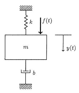
O sistema acima contém um corpo com massa de valor m, uma mola com constante elástica k, e um amortecedor com coeficiente de atrito viscoso b. Uma força externa f(t) provoca um deslocamento y(t) na massa. Com relação a esse sistema, calcule:
