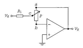
No circuito acima, o amplificador operacional é ideal, com impedância de entrada infinita e ganho diferencial infinito. P é um potenciômetro de resistência total  $R_2$ , tal que a resistência entre os terminais a e c é dada por  $k.R_2$  e a resistência entre os terminais b e c é dada por  $(1-k).R_2$ , onde k varia entre 0 e 1.
