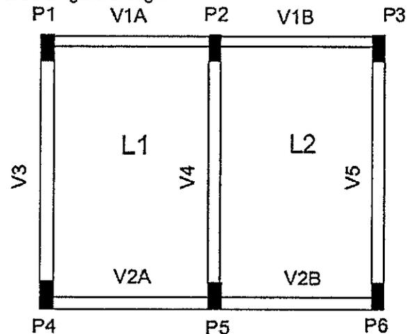
Calcule a quantidade de fôrma necessária para a execução da viga V3 na figura acima, considerando que a distância entre os eixos dos pilares P1 e P4 é de 4,5m e que a seção dos pilares é de 20x50cm, e assinale a opção correta. (Desconsidere perdas).
