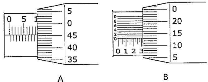
Um mecânico realizará uma medição que necessita de um instrumento que tenha resolução de 0,001 mm, e deverá ser realizada a leitura do instrumento sem nenhum tipo de estimativa visual em sua escala de centésimos de mm. Sendo assim, esse mecânico deverá:
