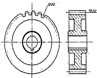
A figura acima representa uma engrenagem cilíndrica de dentes retos com uma simbologia de acabamento superficial. Essa simbologia é indicada no diâmetro:
