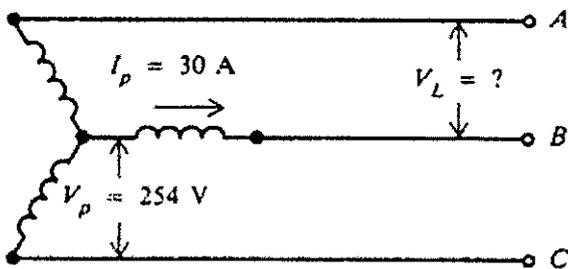
Cada fase de um gerador conectado em estrela entrega uma corrente de 30A a uma tensão de fase de 254V, com um fator de potência de 0,8 atrasado. Determine a potência do sistema trifásico e assinale a opção correta.
