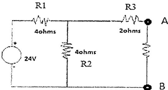
Calcule, respectivamente, os valores de tensão e de resistência de Thevenin entre os pontos A e B da figura acima, e assinale a opção correta.
