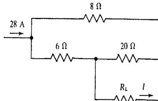
Com base no circuito acima, calcule a corrente  $I$  aproximada, considerando uma resistência  $R_L$  de  $5\Omega$  e assinale a opção correta.
