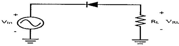
Considerando  $V_{in}$  como um sinal senoidal com tensão média nula, assinale a opção correta da forma de onda da tensão  $V_{RL}$  no resistor.
