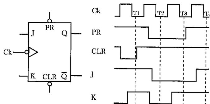
Em função dos sinais aplicados no flip-flop JK da figura acima, determine os valores de Q nos tempos T1, T2, T3 e T4, respectivamente, e assinale a opção correta.
