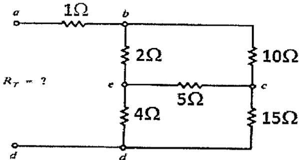
Calcule a condutância entre os pontos a e d, dada em S, do circuito acima e assinale a opção correta.:
