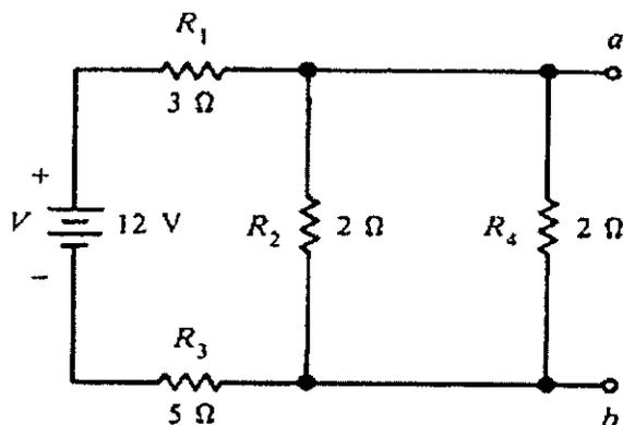
A partir do circuito acima, assinale a opção que apresenta, respectivamente, os valores aproximados de  $R_{TH}$  e  $V_{TH}$  do equivalente Thevenin entre os terminais a e b.
