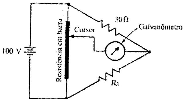
O circuito acima ilustra uma ponte de Wheatstone em que é usada uma resistência em barra. Sabe-se que a barra tem uma resistência uniforme ao longo de seu comprimento, que é de 1m. Se o equilíbrio da ponte ocorre com a barra a uma distância de 25cm do topo, qual será o valor de  $R_x$  e da leitura no galvanômetro, respectivamente, nessa situação?
