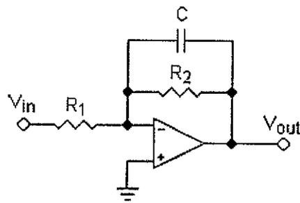
Considerando o circuito do filtro ativo acima, determine qual função ele exerce e sua frequência de corte.
