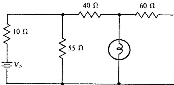
No circuito acima, há uma lâmpada de 120V, 60W. Qual deve ser o valor da tensão de alimentação  $V_s$  para que a lâmpada opere sob condições nominais?
