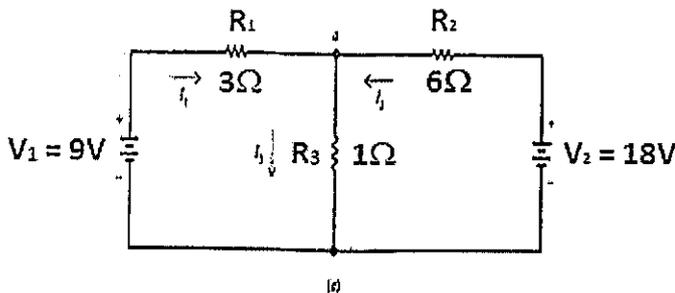
Calcule a tensão no resistor  $R_3$  e assinale a opção correta.
