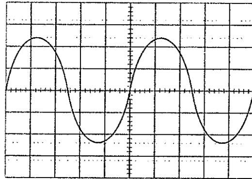
A figura mostra a tela de um osciloscópio durante uma medição. Considerando que a configuração utilizada na escala vertical foi de  $1V/div$  e na escala horizontal foi de  $0,5ms/div$ , determine a frequência e o valor eficaz do sinal medido e assinale a opção correta.
