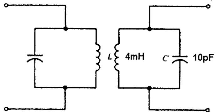
Uma bobina de 4mH e um capacitor de 10pF formam o secundário de um transformador. Determine a frequência de ressonância no secundário em MHz e assinale a opção correta.
