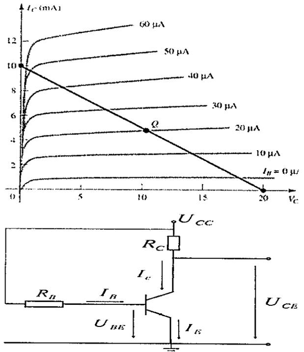
Dados o circuito e o gráfico com as curvas características do transistor bipolar de junção ( $I_C \times V_{CE}$ ) e a reta de carga do circuito descritos nas imagens acima, determine, respectivamente, os valores de  $R_B$  e  $R_C$  que permitam polarizar o transistor no ponto Q assinalado na figura e marque a: opção correta.
