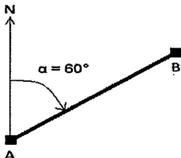
A partir dos dados coletados em campo (ângulos e distâncias), orientação inicial e coordenadas do ponto de partida, é possível calcular as coordenadas dos demais pontos da poligonal. Determine a coordenada do ponto B e assinale a opção correta.
