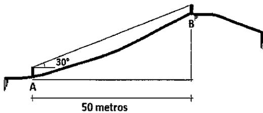
Durante um levantamento trigonométrico, o operador, no ponto A, visualizou a baliza no ponto B com um ângulo de  $30^\circ$ . Admitindo-se a altura do instrumento igual à altura da baliza, qual é o valor da diferença de nível, em metros, entre os dois pontos A e B situados a 50 metros de distância entre si?
