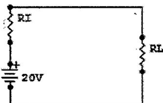
Com base no circuito acima, calcule a potência máxima que a bateria libera para o resistor de carga e assinale a opção correta.
