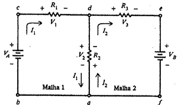
A figura acima ilustra um circuito com duas malhas (malha 1 e malha 2). A malha 1 é formada pelo percurso a-b-c-d-a, e a malha 2 é formada pelo percurso a-d-e-f-a. Com base nessas informações, assinale a opção que apresenta os valores de  $V_1$ ,  $V_2$ ,  $V_3$ ,  $I_1$  e  $I_2$ , respectivamente.
