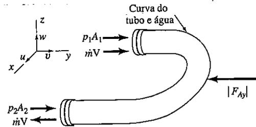
A água escoou através de uma curva horizontal de 180°, como ilustrado na figura acima. A área (A) da seção transversal do escoamento é constante ao longo da curva. A velocidade (V) do escoamento na entrada e na saída da curva é axial. As pressões manométricas na entrada e na saída da curva são P1 e P2, respectivamente. Calcule os componentes horizontais (x e y) da força de ancoragem necessária para manter a curva no lugar e assinale a opção correta.
