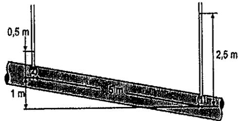
Um líquido incompressível escoa em regime permanente ao longo do tubo, na direção de 1 para 2, como ilustrado na figura acima. Se o diâmetro do tubo é constante ao longo do seu comprimento, qual é o valor, em metros, da perda de carga em 5 m de comprimento do tubo?
