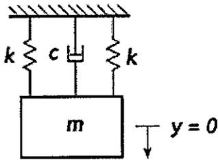
Considerando o sistema massa-mola livremente amortecido apresentado na figura acima, e sabendo que a constante de amortecimento  $c$  é igual a  $85 \text{ N}\cdot\text{s}\cdot\text{m}^{-1}$ , a constante elástica  $k$  da mola vale  $20 \text{ kN/m}$  e a massa  $m$  do objeto equivale a  $100 \text{ kg}$ , a frequência natural do sistema é igual a:
