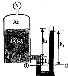
Determine uma equação para encontrar a pressão no nível (1), em função da pressão do ar e do peso específico do óleo que estão no tanque fechado e assinale a opção correta.
