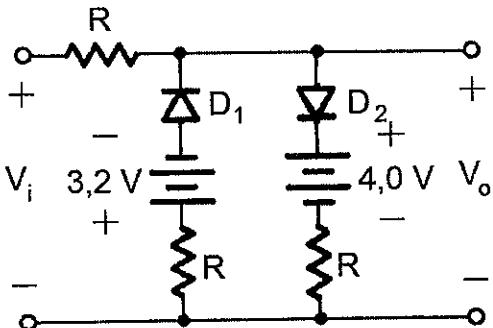
Considere o circuito limitador acima, em que os diodos D1 e D2, em condução, possuem queda de tensão constante de 0,7 V e 0,8 V, respectivamente. Para uma tensão de entrada  $v_i(t) = 5,5 \cdot \sin(\omega \cdot t)$ , assinale a opção que apresenta o período de tempo, em porcentagem, em que o sinal não é limitado pelo circuito.
