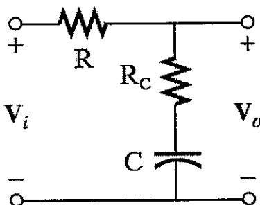
Considere o filtro passa-baixas acima, com tensão de entrada  $V_i$ , tensão de saída  $V_o$  e atenuação limitada pelo resistor  $R_C = 10 \Omega$ . Assinale a opção que apresenta a atenuação máxima em dB e a frequência de corte em rad/s.
