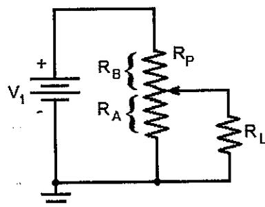
Determine, respectivamente, o valor da resistência  $R_A$  do potenciômetro para que ocorra a máxima transferência de potência no resistor  $R_L$  e o valor potência  $P_L$  no resistor  $R_L$  para essa condição e assinale a opção correta.
