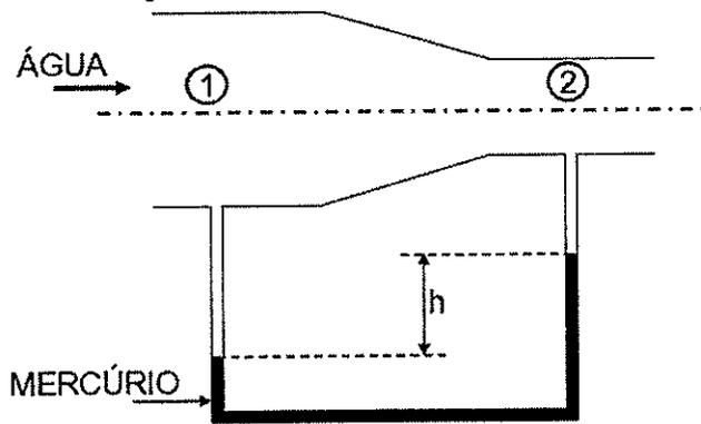
A figura acima representa água escoando em uma tubulação de seção circular que contém um manômetro por altura de coluna de mercúrio entre os pontos 1 e 2.
