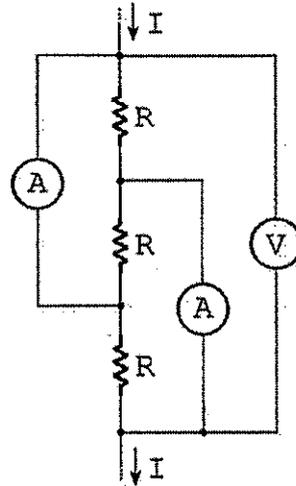
No trecho de circuito apresentado na figura acima, o voltímetro e os amperímetros são ideais e indicam 4V e  $\frac{8}{3}$  A (leitura igual nos dois amperímetros). As resistências possuem valor  $R$  desconhecido. Assim, a corrente  $I$  tem o valor de:
