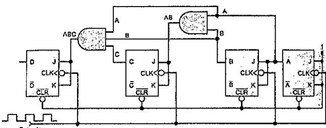
Determine sua  $f_{max}$  sabendo que o tempo de atraso de propagação ( $t_{pd}$ ) de cada Flip-Flop é de 50ns e o  $t_{pd}$  de cada porta AND é de 20ns e assinale a opção correta.
