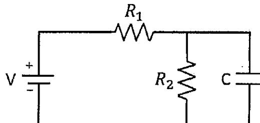
Nele, o capacitor de capacidade  $C$  está inicialmente descarregado. Determine as expressões matemáticas para o comportamento transitório da tensão sobre o capacitor  $v_c(t)$  e da corrente elétrica sobre o capacitor  $i_c(t)$ , para  $t \geq 0$ , e assinale a opção correta.
