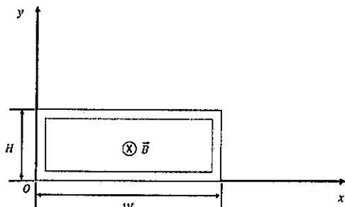
A intensidade do vetor indução magnética é dada por  $B(t, x) = 4t^2x^2$ , em que a variável  $t$  representa o instante de tempo e a variável  $x$  representa um valor de abscissa no sistema de coordenadas cartesianas  $xOy$ . Determine o módulo da força eletromotriz  $\varepsilon$  induzida na espira e assinale a alternativa correta.
