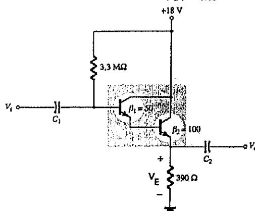
Calcule a tensão  $V_E$  para o circuito polarizado em Corrente Contínua, considerando que a tensão entre base e emissor de ambos os transistores é de 0,7V e assinale a opção correta.
