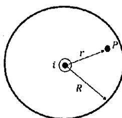
Essa figura mostra um fio longo, retilíneo, com seção transversal circular de raio  $R$ , percorrido por uma corrente elétrica uniforme de intensidade  $i$  dirigida para fora do plano do papel. A distribuição dessa corrente elétrica ao longo da seção transversal do fio é uniforme. Determine a intensidade do vetor indução magnética  $\vec{B}$  em um ponto  $P$  a uma distância  $r \leq R$  do eixo do fio e assinale a opção correta.
