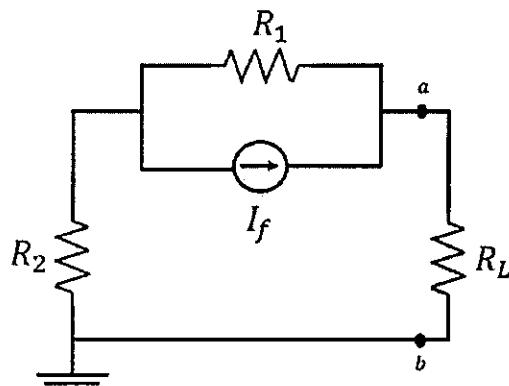
Nele,  $R_1 = 5\Omega$ ,  $R_2 = 4\Omega$ ,  $R_L = 9\Omega$  e  $I_f = 10A$ . Determine a resistência equivalente  $R_N$  e a corrente  $I_N$  do circuito equivalente de Norton entre os terminais a e b e assinale a opção correta.
