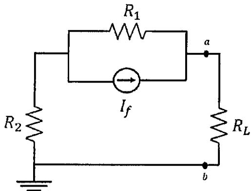
Nele,  $R_1 = 5\Omega$ ,  $R_2 = 4\Omega$ ,  $R_L = 9\Omega$  e  $I_f = 10A$ . Determine a resistência equivalente  $R_N$  e a corrente  $I_N$  do circuito equivalente de Norton entre os terminais a e b e assinale a opção correta.
