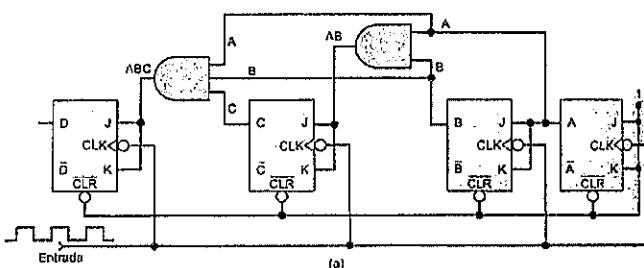
Determine sua  $f_{max}$  sabendo que o tempo de atraso de propagação ( $t_{pd}$ ) de cada Flip-Flop é de 50ns e o  $t_{pd}$  de cada porta AND é de 20ns e assinale a opção correta.
