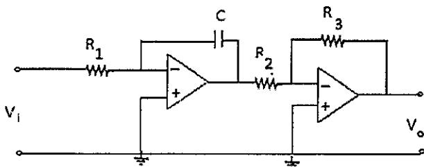
Sobre esse circuito, qual é a função de transferência  $G(s)$  e em que ação de controle ele pode ser utilizado?
