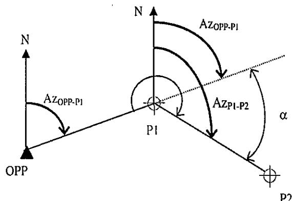
Calcule o valor do azimute de P1 para P2, sabendo que o azimute de OPP para P1 é de  $60^{\circ} 45'$  e que o ângulo  $\alpha$  é de  $45^{\circ} 30'$  e assinale a opção correta.
