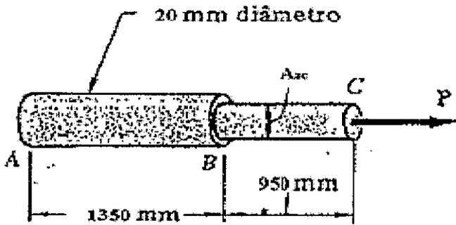
Sabendo que  $E = 245 \text{ GPa}$ , calcule a área da parte BC para a qual o deslocamento do ponto C seja de  $1,9 \text{ mm}$  e assinale a opção correta.
