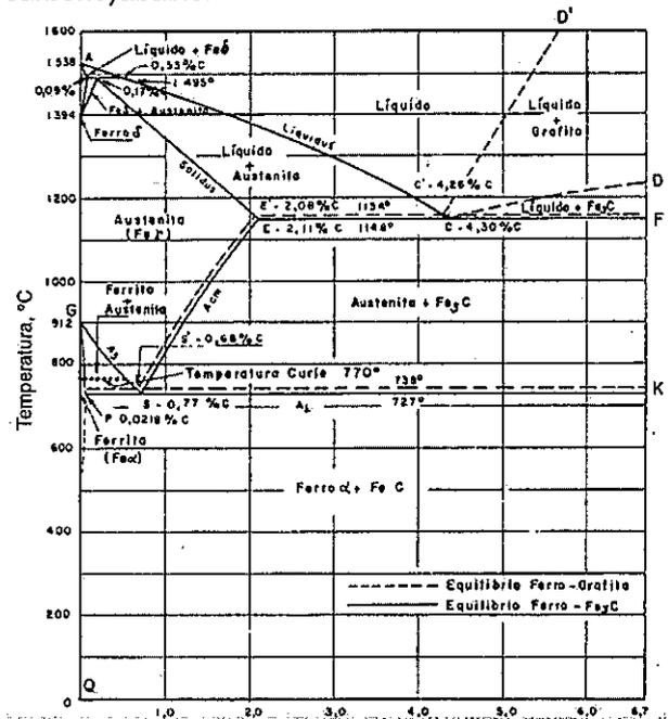
No diagrama de equilíbrio Fe-C (ferro-carbono), o aço com 0,3% de carbono para uma dada temperatura se mantém localizado na região compreendida entre a linha "solidus" (sólido) e o limite superior da linha "A3". Sendo assim, assinale a opção correta sobre a estrutura desse aço.
