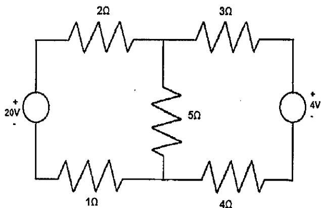
Sabendo que o conceito elétrico acima é alimentado por fontes de tensão contínuas, utilize a lei de tensão de Kirchhoff para determinar a tensão e a corrente no resistor de  $5\Omega$  e assinale a opção correta.
