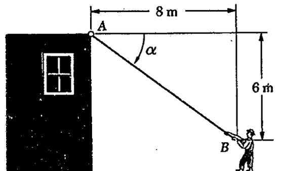
Um homem puxa, com uma força de 500 N, uma corda fixada a um prédio, como mostra a figura acima. Qual o módulo das componentes horizontal e vertical, respectivamente, da força exercida pela corda no ponto A?
