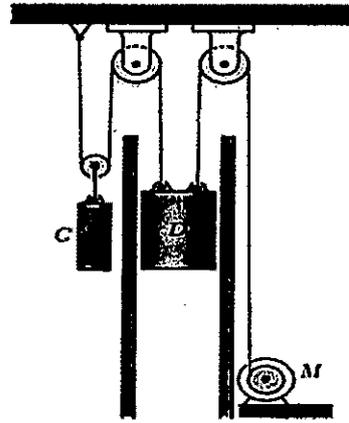
O peso  $D$  de 2000 N e o contrapeso  $C$  de 3000 N estão ligados a um motor elétrico  $M$ , como apresenta a figura acima. Determine a potência aproximada desenvolvida pelo motor  $M$  quando  $D$  está subindo com velocidade constante de  $2,5 \text{ m/s}$  e assinale a opção correta.
