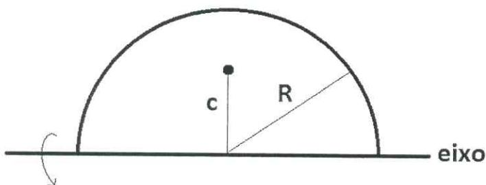
Determine o valor do centroide  $c$  dessa semicircunferência de raio  $R = 2$  m, que gira em torno de um eixo como na figura acima, sabendo que a área da superfície da esfera vale  $16\pi \text{ m}^2$  e assinale a opção correta.
