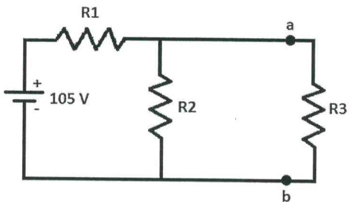
Determine o valor do resistor de Norton ( $R_N$ ) e da corrente de Norton ( $I_N$ ) do circuito externo, sendo  $R_1 = 15 \Omega$  e  $R_2 = 30 \Omega$ , e assinale a opção correta.
