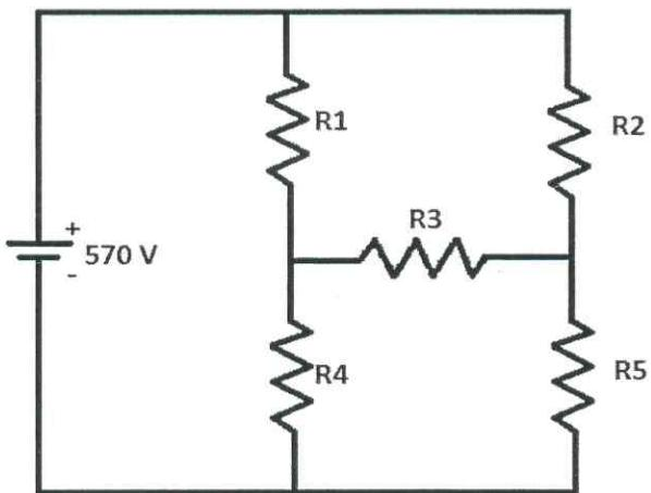
Com base nesse circuito, determine a corrente fornecida pela fonte de 570 Volts, sendo  $R_1=R_2=R_3=R_4=R_5=30\ \Omega$ , e assinale a opção correta.
