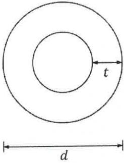
O tubo de seção transversal circular de diâmetro externo  $d = 5 \text{ cm}$  e espessura de parede  $t = 1 \text{ cm}$ , conforme ilustrado na figura acima, é submetido a uma força longitudinal de tração de módulo  $32\pi \text{ kN}$ . Com base nessas informações, assinale a opção que apresenta a tensão normal resultante.
