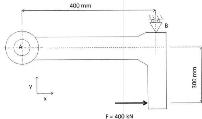
O dispositivo especial de massa desprezível mostrado acima está fixado por uma rótula no ponto A e apoia-se sobre roletes no ponto B, resistindo à força de módulo  $F$ , conforme mostrado no arranjo. Considerando uma situação de equilíbrio estático, assinale a opção que apresenta o módulo das forças de reação  $R_A$  e  $R_B$  atuantes, respectivamente, nos pontos A e B.
