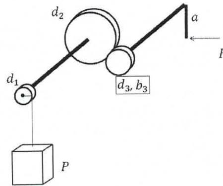
Deseja-se projetar uma transmissão, conforme apresentado na figura acima. A força de módulo  $F$  aplicada na manivela é utilizada para elevar o bloco de peso  $P$  ligado à polia, localizada na extremidade do eixo movido. Assim, assinale a opção que apresenta o diâmetro  $d_3$  e a largura do dente  $b_3$  da engrenagem indicada na figura sabendo que o momento torçor máximo  $M_T$  suportado por esse elemento é dado por:  $M_T = kb_3d_3^2$ , onde  $K$  representa uma constante conhecida.
