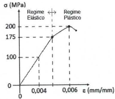
Considere a curva tensão-deformação ( $\sigma$ - $\epsilon$ ) de engenharia obtida por meio de um ensaio de tração de determinado material metálico apresentada acima. O módulo de elasticidade e o limite de escoamento do material são, respectivamente:
