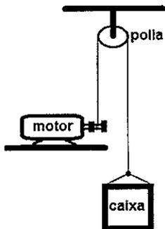
Desconsiderando os efeitos da resistência do ar e sabendo que a potência mecânica do motor é  $1000\text{W}$  e que o deslocamento vertical da caixa é  $8\text{m}$ , determine o tempo que o motor leva para erguer a caixa e marque a opção correta. Dado:  $g = 10\text{m/s}^2$
