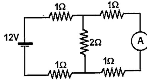
Considerando o amperímetro ideal, o valor da corrente elétrica indicada no amperímetro é:
