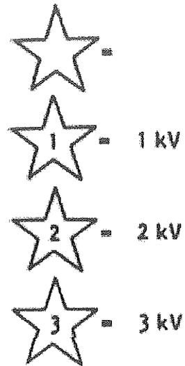
Tensão de isolamento ou tensão de prova é o valor máximo de tensão que um instrumento pode receber entre sua parte interna (de material condutor) e sua parte externa (de material isolante). Pode-se afirmar que no esquema acima quando somente uma estrela tiver marcações (sem números), haverá uma tensão de isolamento no valor de
