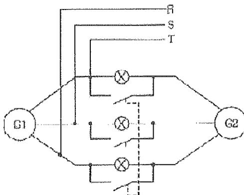
Um navio apresenta uma planta elétrica (figura acima) com dois geradores, sendo que o primeiro gerador (G1), já está ligado ao barramento. Quando o oficial de máquinas foi colocar o segundo gerador em barra, observou que as lâmpadas do sincronoscópio estavam apagadas. Pode-se afirmar que isso é uma característica de que, neste momento, tem-se uma sincronização que precisa apenas:
