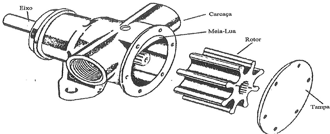
A figura acima representa um tipo de bomba comum usada para a circulação de água salgada para resfriamento de motores de embarcações de pequeno e médio porte. De acordo com Lima (2003), qual o nome dessa bomba?
