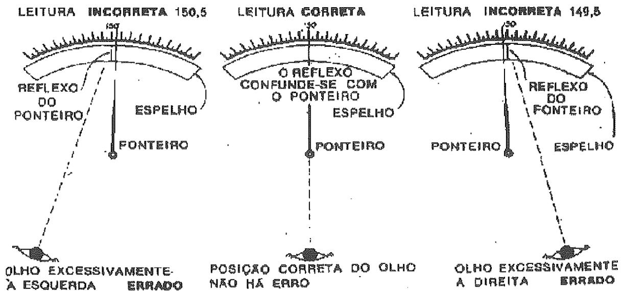
Quando se trabalha com instrumento de medidas analógicos, pode-se cair num erro clássico provocado pelo posicionamento de leitura, conforme as figuras acima. Assinale a opção que apresenta esse erro.
