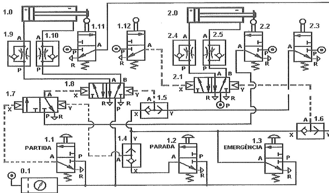
Pode-se afirmar que no diagrama de controle do Navio N/M BODE, apresentado acima, a válvula tipo 5/2-NA em B/ Pilotagem dupla pneumática é a:
