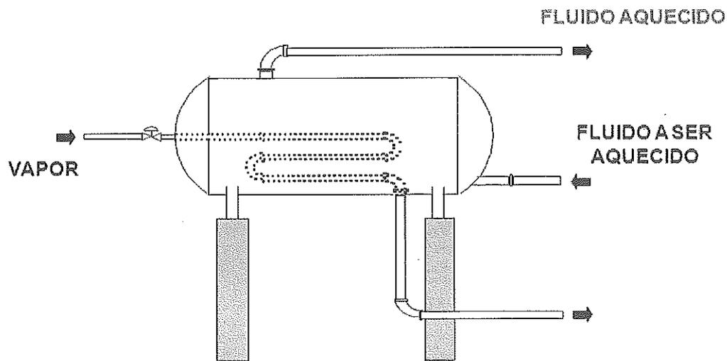
A figura acima representa uma linha de controle de uma caldeira de recuperação de um navio no qual encontra-se um elemento de controle (agente de controle) e uma variável a ser controlada. Baseado nessa planta, assinale a opção que apresenta, respectivamente, esses itens.
