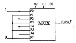
Assinale a opção que corresponde à saída f do MUX na figura acima, em função dos bits de seleção S2, S1 e S0.
