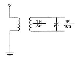
O circuito acima executa a sintonia de um receptor de rádio simples. Sendo assim, calcule a frequência de ressonância desse circuito e assinale a opção correta.
