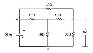
Calcule o valor da resistência equivalente entre os pontos A e B e a tensão de saída Vo do circuito acima, respectivamente, e assinale a opção correta.
