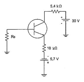
Com relação ao circuito acima, qual a tensão coletoremissor e qual o tipo de polarização do circuito?
