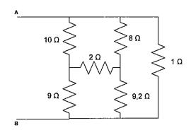
Com relação a esse circuito, calcule a resistência equivalente entre os pontos A e B e assinale a opção correta.
