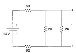
Calcule a corrente e a resistência de Norton ( $I_N$  e  $R_N$ ), respectivamente, do circuito acima, e assinale a opção correta.
