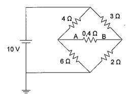
Com relação ao circuito acima, calcule a corrente no resistor de  $0,4\Omega$ , entre os pontos A e B da ponte de resistores, e assinale a opção correta.
