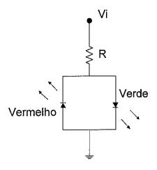
Com relação a esse circuito, marque a opção que apresenta o LED que irá acender para uma fonte de tensão (Vi) negativa e calcule o resistor R para garantir uma corrente de 20 mA através do diodo ligado.
