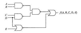
Assinale a opção que apresenta a expressão lógica equivalente à função f (A, B, C, D, E) em função das entradas A, B, C, D e E no circuito acima.
