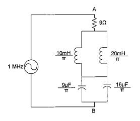
Com base no circuito acima, calcule a impedância equivalente entre os pontos A e B e assinale a opção correta.
