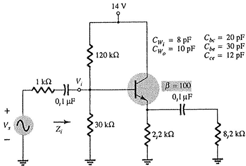
Com base no circuito da figura acima, determine a frequência de corte inferior e assinale a opção correta.
