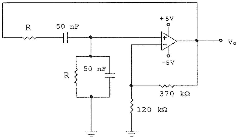
Deseja-se projetar um circuito oscilador tipo ponte de Wien, conforme a figura acima, de modo que a saída  $V_o$  seja um sinal oscilante com frequência 2 kHz. Sendo assim, assinale a opção que indica o valor R para o qual o circuito satisfaz essas condições.
