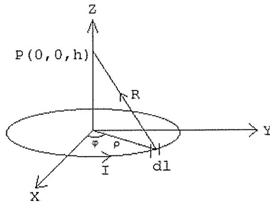
Uma espira circular localizada em  $x^2+y^2 = 9$  é percorrida por uma corrente contínua de 10A ao longo de  $\vec{a}_\varphi$ , onde  $\vec{a}_\varphi$  é o vetor unitário em torno do ângulo  $\varphi$ . Sendo assim, determine H em  $(0,0,4)$  e assinale a opção correta.
