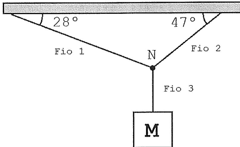
Na figura acima, um bloco de massa  $M$  está suspenso em equilíbrio por um fio partindo de um nó  $N$ , que está preso a um teto por meio de dois outros fios. Considere que os fios tenham massa desprezível e que o módulo da força gravitacional no nó também seja desprezível quando comparada à força que age sobre o bloco. O módulo da tração no Fio 1 equivale a que porcentagem do peso do bloco?
