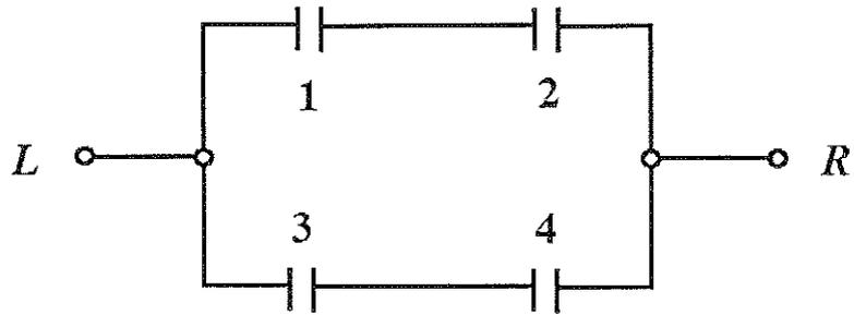
A probabilidade de fechamento de cada relé do circuito apresentado na figura acima é dada por  $p$ . Se todos os relés funcionarem independentemente, qual será a probabilidade de que haja corrente entre os terminais L e R?
