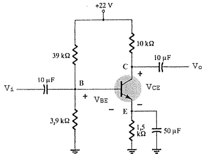
Calcule o valor da tensão  $V_{CE}$  para a configuração do circuito acima e assinale a opção correta.
