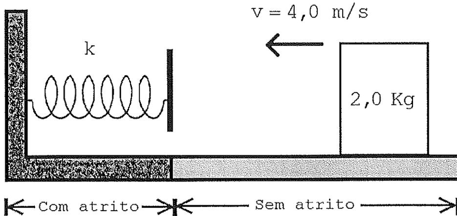
Um bloco de massa 2,0 kg desliza em um piso sem atrito, com velocidade  $v = 4,0 \text{ m/s}$ , e colide com um anteparo preso a uma mola, comprimindo-a até o bloco parar por um instante. Na região de compressão da mola, o piso exerce uma força de atrito cinético com intensidade de 15,0 N. Considerando a constante da mola  $k = 10,0 \text{ kN/m}$ , assinale a opção que apresenta a distância, em centímetros, referente à compressão da mola no instante em que o objeto para.
