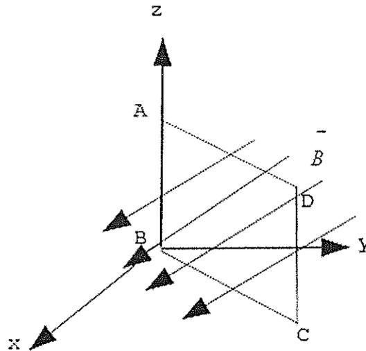
Um campo magnético uniforme de  $0,05ax$  Wb/m atravessa a espira ABCD, conforme a figura acima. Considerando que o lado CD está girando em torno do eixo z, com velocidade angular  $100\pi$  rad/s, e, no instante  $t=0$ , a espira encontra-se no plano  $x=0$ , determine a força eletromotriz induzida quando  $t= 5,0$  ms e assinale a opção correta.
