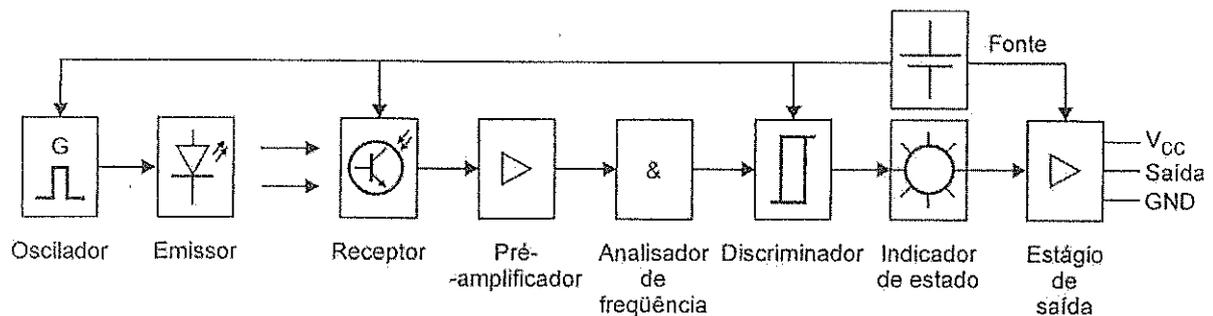
O princípio de funcionamento do sensor óptico baseia-se na existência de um emissor e de um receptor. A luz gerada pelo emissor deve atingir o receptor com intensidade suficiente para fazer com que o sensor comute sua saída. Considerando o diagrama de blocos da figura acima, em qual bloco ocorre o ajuste do sinal modulado para níveis compatíveis com o circuito eletrônico do sensor?
