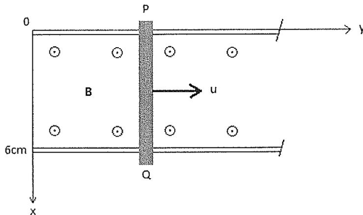
Calcule a tensão induzida na barra se a mesma estiver parada em  $y=8\text{cm}$  e  $B = 4 \cdot \cos(10^6 t) \vec{a}_z$  mWb/m<sup>2</sup>, e assinale a opção correta.
