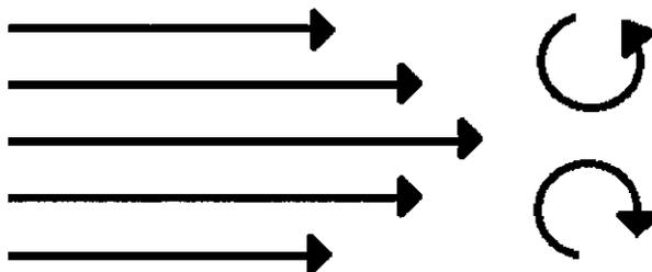
De acordo com a figura acima, mesmo no movimento em linha reta dentro de um fluido, pode existir tendência de rotação dentro do escoamento, quando a velocidade varia segundo a normal ao eixo do escoamento. Assim, como é chamada a medida microscópica da rotação em cada ponto da atmosfera?
