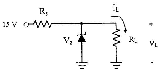
Com base nessa figura, calcule  $R_s$  e  $V_z$  para manter  $V_L$  em 9V, para uma variação de carga de 0 a 300 mA, e assinale a opção correta.
