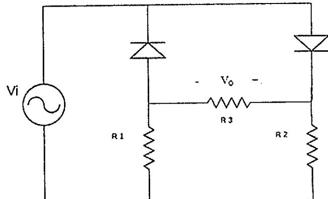
Sabendo que os diodos são ideais, calcule o nível CC de saída e a PIV (Tensão de pico inversa) requerida para cada diodo respectivamente, e assinale a opção correta.
