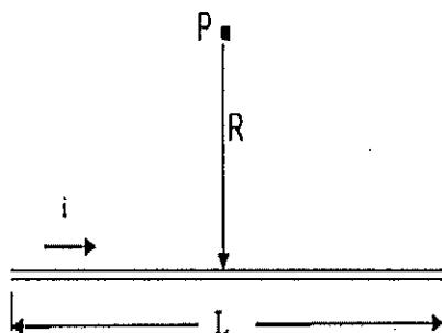
Na figura representada acima, o ponto P está a uma distância  $R = 12 \text{ m}$  do ponto médio de um fio retilíneo de comprimento  $L = 20 \text{ m}$ , que conduz uma corrente  $i = 60 \text{ mA}$ . Qual é o módulo do campo magnético no ponto P?
