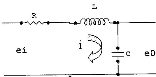
Considerando as condições iniciais nulas, calcule a função de transferência  $\frac{E_0(s)}{E_i(s)}$  do circuito e assinale a opção correta.
