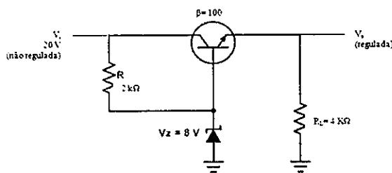
Com base no circuito regular acima, calcule a tensão de saída ( $V_o$ ) e a corrente no diodo zener ( $I_z$ ), respectivamente, e assinale a opção correta.
