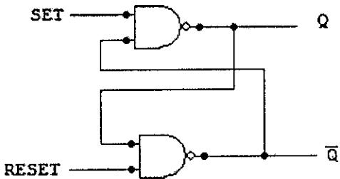
O circuito de um Flip-Flop (FF) mais simples pode ser construído a partir de duas portas NAND ou duas portas NOR. Assim, assinale a opção correta sobre as saídas do circuito representado acima:
