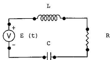
A corrente no circuito em série de malha simples depois que a chave é fechada é denotada por  $i(t)$  e a carga em um capacitor no instante  $t$  é denotada  $q(t)$ . Sendo assim, assinale a opção que apresenta a equação diferencial obtida aplicando a 2ª lei de kirchoff.
