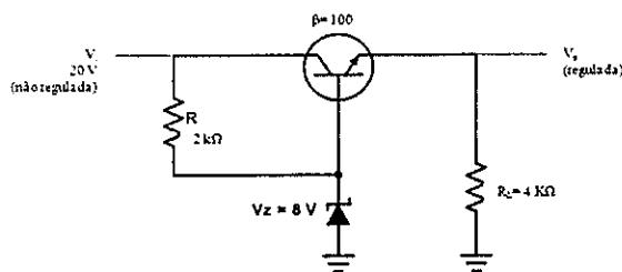
Com base no circuito regular acima, calcule a tensão de saída ( $V_o$ ) e a corrente no diodo zener ( $I_z$ ), respectivamente, e assinale a opção correta.
