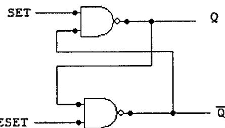
O circuito de um Flip-Flop (FF) mais simples pode ser construído a partir de duas portas NAND ou duas portas NOR. Assim, assinale a opção correta sobre as saídas do circuito representado acima:
