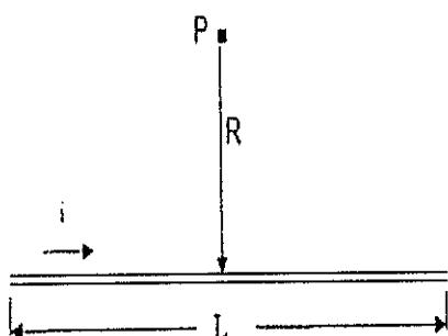
Na figura representada acima, o ponto P está a uma distância  $R = 12 \text{ m}$  do ponto médio de um fio retílineo de comprimento  $L = 20 \text{ m}$ , que conduz uma corrente  $i = 60 \text{ mA}$ . Qual é o módulo do campo magnético no ponto P?
