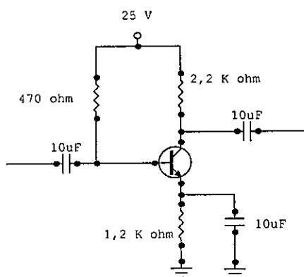
Os valores de  $I_b$ ,  $I_c$ ,  $V_{CE}$ ,  $V_C$  e  $V_E$  para o circuito de polarização do emissor da figura acima são, respectivamente:
