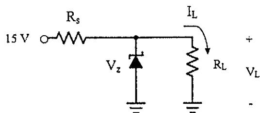
Com base nessa figura, calcule  $R_s$  e  $V_z$  para manter  $V_L$  em 9V, para uma variação de carga de 0 a 300 mA, e assinale a opção correta.
