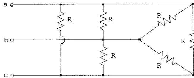
A figura acima representa duas cargas trifásicas equilibradas. Assinale a opção que corresponde à resistência estrela equivalente ( $R_e$ ) vista pelos terminais a, b e c do circuito representado nessa figura.
