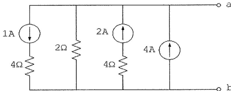
Assinale a opção que corresponde ao valor da tensão entre os terminais "a" e "b" da figura acima.
