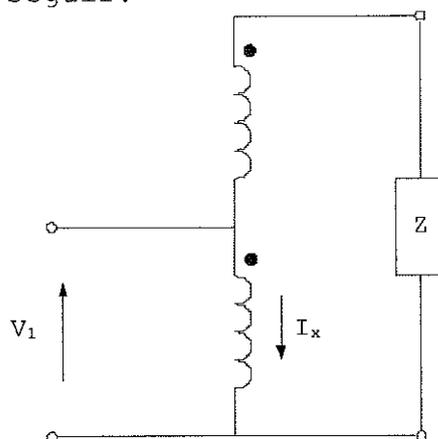
A figura acima representa um autotransformador monofásico ideal 220V/380V que alimenta uma carga Z de 41,8kVA. Sabendo que  $V_1=220V$ , assinale a opção que corresponde ao valor da corrente  $I_x$ .
