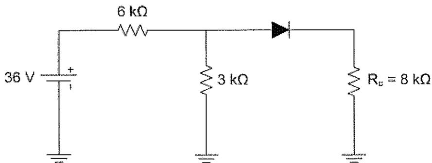
Para o circuito ilustrado acima, considere o diodo com resistência interna de  $0\Omega$  e tensão de  $0,7V$  sobre o diodo quando este estiver diretamente polarizado. Assinale a opção que corresponde ao valor da corrente aplicada em  $R_C$ .
