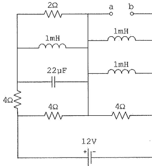
Admitindo-se que o circuito acima está em regime permanente e que possui componentes elétricos passivos e ideais em seus parâmetros concentrados, assinale a opção que apresenta o valor da tensão entre os terminais "a" e "b".
