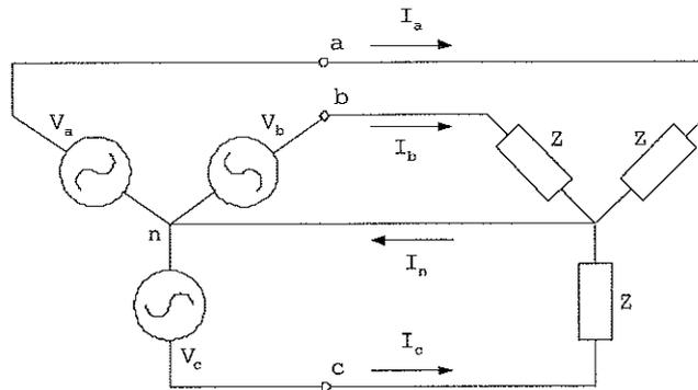
A figura acima representa um gerador trifásico, com tensões balanceadas cujos módulos são 240V, e uma carga trifásica equilibrada, onde  $|Z|=12\Omega$ . Assinale a opção que corresponde ao valor da corrente  $I_n$ .
