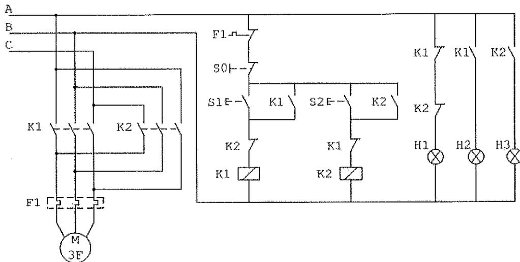
A figura acima representa um diagrama de força e comando de um motor de indução trifásico com três terminais acessíveis. Assinale a opção que corresponde ao tipo de chave representada no diagrama acima.
