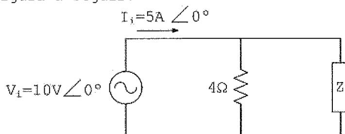
A figura acima representa um circuito de corrente alternada. Assinale a opção que apresenta a potência, em Watt, fornecida pela fonte à carga Z.
