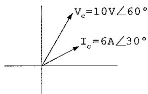
Uma determinada carga monofásica apresenta tensão e corrente iguais a  $V_c$  e a  $I_c$ , respectivamente, como representado na figura acima. Assinale a opção que corresponde ao valor da potência reativa dessa carga.
