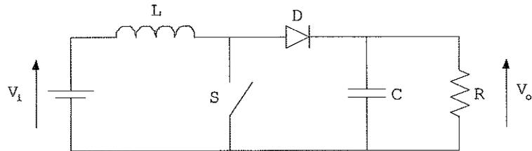
A figura acima representa um conversor CC/CC, na qual  $S$  é uma chave ativa que opera em alta frequência de chaveamento. Como se denomina esse conversor?
