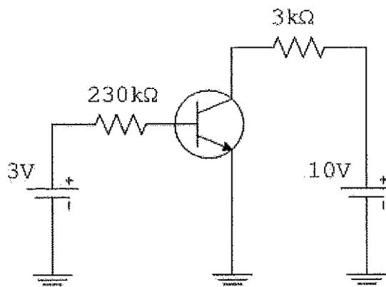
No circuito da figura acima, considere a tensão entre base e emissor para o transistor tipo NPN igual a  $0,7\text{V}$  e seu ganho de corrente é igual a 100. Assinale a opção que corresponde, respectivamente, às correntes de base ( $I_B$ ) e de coletor ( $I_C$ ).
