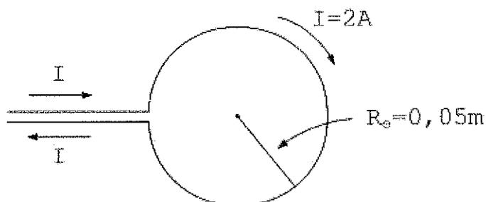
A figura acima representa um condutor em forma de espira de raio  $R_g$ , o qual é percorrido por uma corrente  $I=2\text{A}$ . Assinale a opção que apresenta o valor da intensidade de campo magnético no centro da espira.
