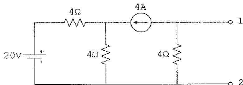
A figura acima representa um circuito de corrente contínua com os terminais 1 e 2 em aberto.
