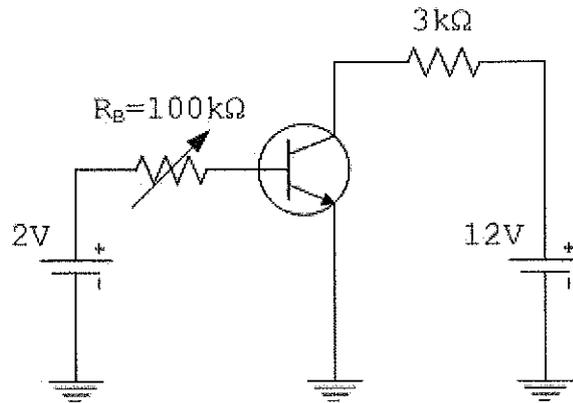
No circuito da figura acima, considere  $R_B$  um resistor variável cuja resistância pode ser ajustada entre  $0\Omega$  e  $100k\Omega$ . Considere ainda que, quando o transistor estiver funcionando na região de saturação, a tensão entre coletor e emissor será considerada nula ( $V_{CE} = 0$  Volts). Assinale a opção que corresponde, respectivamente, à corrente do coletor no ponto de saturação do transistor e à tensão entre coletor e emissor no ponto de corte do dispositivo.
