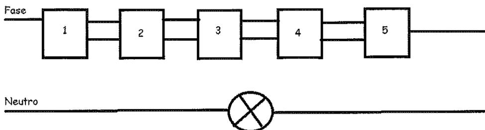
Por vezes, para se comandar um circuito de iluminação, é necessário existir a possibilidade de comando por vários pontos. Assinale a opção que apresenta a sequência correta de interruptores (1-2-3-4-5) que permite que o circuito representado na figura acima seja comandado por qualquer interruptor.
