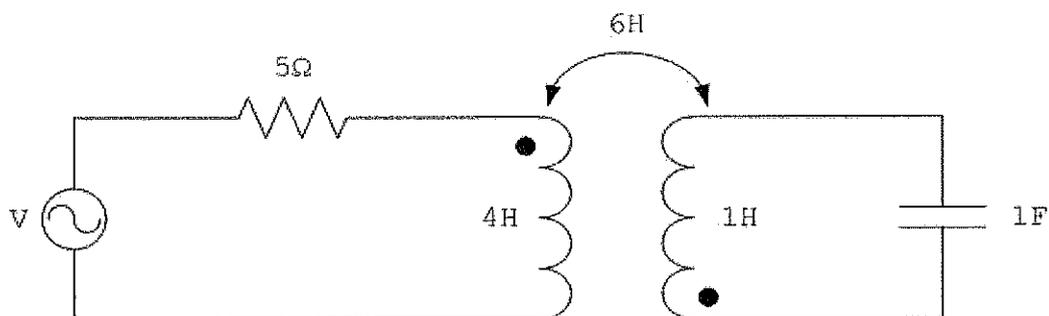
O coeficiente de acoplamento do transformador presente no circuito acima é:
