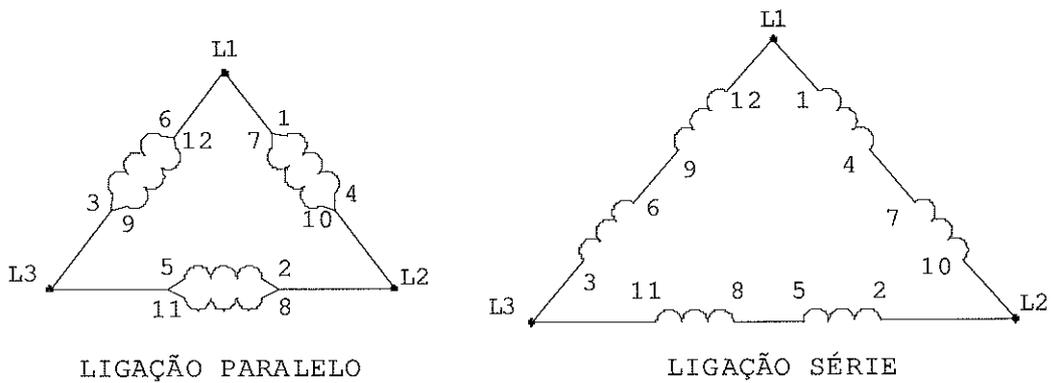
As figuras acima representam duas configurações de ligações entre bobinas de um motor de indução trifásico de doze terminais.
