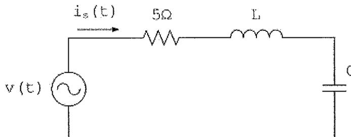
A tensão da fonte da figura acima é dada por  $v(t) = 100\sqrt{2} \cos(120\pi t - 60^\circ) \text{V}$ .
