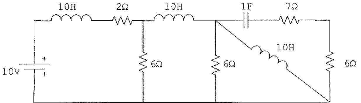
Com relação a esse circuito, suponha que os componentes elétricos são passivos ideais com parâmetros concentrados. Sendo assim, determine o valor da corrente em regime permanente fornecida pela bateria, e assinale a opção correta.
