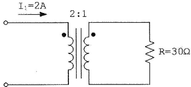
A figura acima representa uma carga  $R=30\Omega$  alimentada por um transformador monofásico ideal, em que a corrente do primário é 2A. Assinale a opção que apresenta o valor de potência dissipada na carga em Watt.
