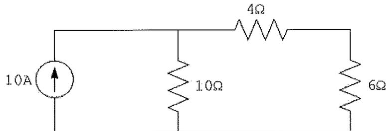
Determine a potência dissipada pelo resistor de  $6\Omega$ , e assinale a opção correta.
