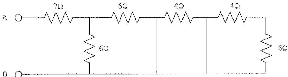
Determine a resistência equivalente entre os pontos A e B do circuito acima, e assinale a opção correta.
