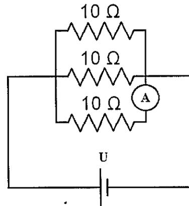
O circuito elétrico representado acima é composto por uma bateria ideal, fios de resistência elétrica desprezível e resistores idênticos cuja resistência elétrica é de  $10 \Omega$  cada. A corrente elétrica indicada no amperímetro ideal A é de 3 A. Sendo assim, calcule a tensão U (diferença de potencial elétrico), em volts, nos terminais da bateria e assinale a opção correta.
