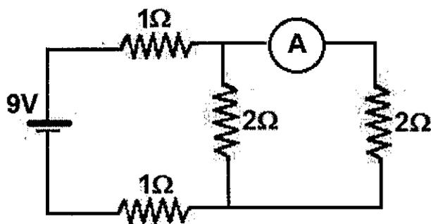
O circuito elétrico apresentado acima foi construído utilizando uma bateria de 9 V, vários resistores e um amperímetro ideal. O valor da corrente elétrica indicada no amperímetro é:
