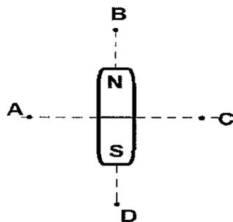
A figura acima apresenta um experimento com ímã. Nesse experimento uma pequena bússola é colocada próximo ao ímã permanente, nas posições (A, B, C e D) indicadas na figura. Em quais dessas posições (A, B, C e D), a extremidade norte da agulha da bússola apontará para cima, ou seja, para o topo?
