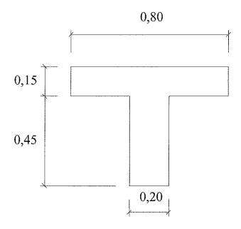
Com base na seção de viga T representada acima, cujas dimensões estão em metros, qual é o volume de concreto da mesma, considerando que seu comprimento é de 5m?
