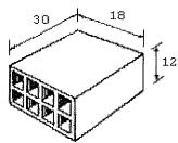
Quantos tijolos são necessários para fazer uma parede de meia vez de alvenaria com dimensões de 15 m de comprimento, 12 cm de largura e 3,6m de altura, utilizando o tijolo da figura acima (tijolo furado de oito furos, cujas dimensões são: 30,0 x 18,0 x 12,0 cm) e desprezando a argamassa de assentamento?
