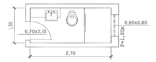
Observando a planta acima, calcule a quantidade de azulejos para revestir as paredes do banheiro, do piso ao teto, considerando que o pé-direito é de 2,60 metros e que haverá uma perda de 15% na instalação. Assinale a opção que mais se aproxima desse quantitativo.
