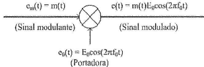
O princípio da modulação representado pelo diagrama acima consiste no fato de que o sinal modulante influencia exclusiva e diretamente a amplitude da portadora. Sabendo que a frequência máxima do sinal modulante  $e_m(t)$  em banda base é  $f_m$  e que a frequência da portadora é  $f_0$ , muito maior que  $f_m$ , qual é a banda ocupada pelo sinal modulado?
