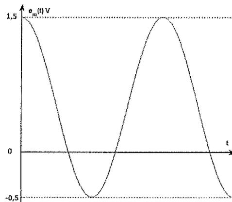
Na modulação AM-DSB, o sinal modulado,  $e(t)$ , pode ser escrito como  $e(t) = [E_0 + e_m(t)] \cos(2\pi f_0 t)$ . Sabendo que  $E_0 = 1$  V, quais dos sinais modulantes,  $e_m(t)$ , acima, podem ser recuperados usando o método de detecção de envoltória?
