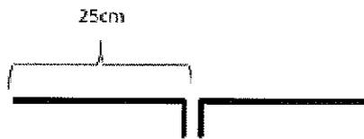
Calcule a frequência para a qual um dipolo de meia onda foi projetado para operar, sabendo que metade do seu comprimento é 25cm, conforme mostra a figura acima, e assinale a opção correta.
