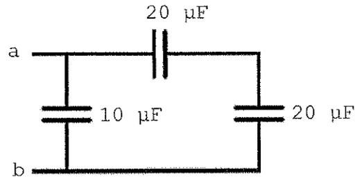
Calcule a capacitância equivalente entre os pontos a e b do circuito acima, e assinale a opção correta.
