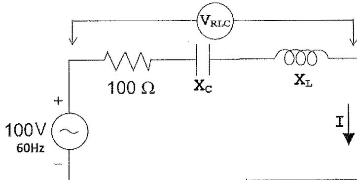
Qual é o ângulo formado entre o fasor da corrente alternada  $I$  e o fasor da tensão  $V_{RLC}$ , quando o valor da reatância capacitiva  $X_c$  for igual ao valor da reatância indutiva  $X_L$ ?
