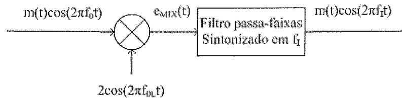
Um receptor realiza o produto do sinal AM-DSB-SC com o sinal de um oscilador local sintonizado em  $f_{oL}$ . O sinal resultante  $e_{MIX}(t)$  é o resultado da conversão da frequência da portadora  $f_0$  para uma frequência intermediária  $f_I$ , conforme mostra o diagrama acima.
