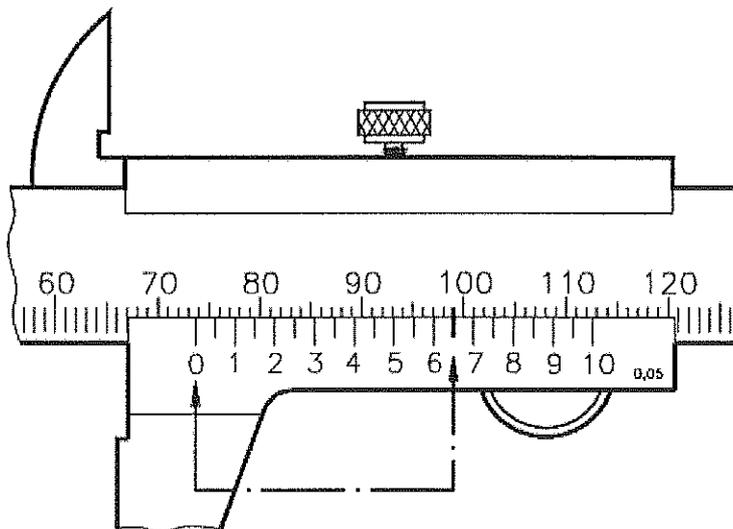
A figura acima representa uma medição com paquímetro, sendo a escala em milímetros e o nônio com 20 divisões. Qual é a leitura indicada, em milímetros?
