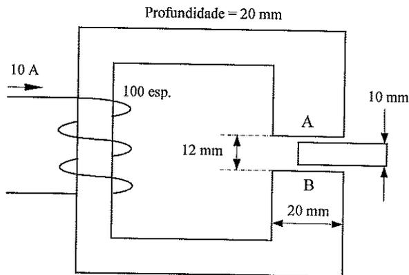
A armadura móvel é mantida centrada entre as faces A e B por suportes sem atrito não mostrados.
