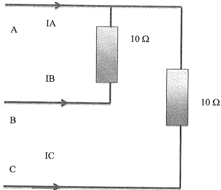
Para esse circuito alimentado por um sistema trifásico em CA, em 60 Hz e com as tensões  $V_{AB} = 220 \angle 0^\circ$  V,  $V_{BC} = 220 \angle -120^\circ$  V e  $V_{CA} = 220 \angle 120^\circ$  V, determine:
