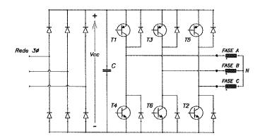
O esquema de potência de um conversor estático de frequência para alimentação de um motor de indução é apresentado na figura acima. A tensão da linha de alimentação trifásica tem valor eficaz de 220V e 60 Hz. Sendo assim:
