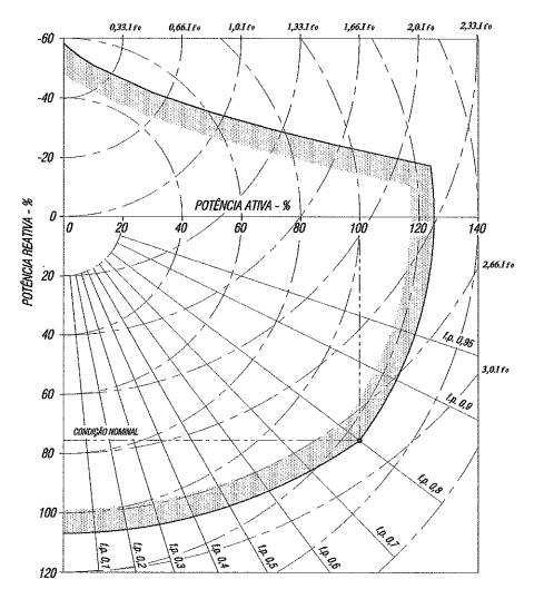
Um turbo-gerador de 2 polos, 30 MVA, 17 kV -  $\cos \varphi = 0.8$ , tem seu diagrama de capabilidade apresentado acima, na qual a grandeza  $I_{f0}$  é a corrente de excitação requerida para gerar, no estator, a tensão nominal em vazio. Sendo assim:
