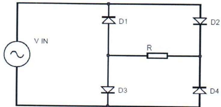
O circuito representado acima é um retificador em ponte de onda completa.
