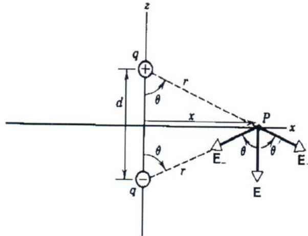
Considere que as cargas positiva e negativa do dipolo acima são de igual módulo "q" e separadas por uma distância d. Determine o valor do campo elétrico E no ponto p situado a uma distância x do centro do dipolo, e assinale a opção correta.
