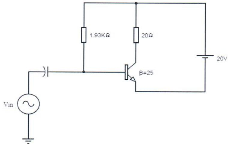
Calcule a eficiência do circuito amplificador Classe A mostrado acima, considerando uma tensão de entrada  $V_{in}$  que resulte em uma corrente de base  $I_b$  de  $10mA$  de pico, e assinale a opção correta.
