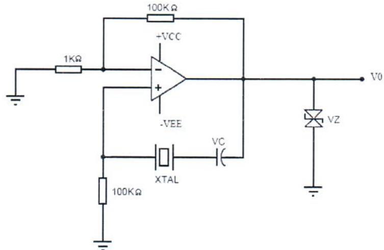
O circuito acima é um oscilador a cristal cuja forma de onda na saída  $V_0$  é dada por uma onda quadrada.
