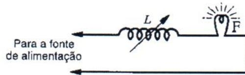
Considere que o controlador de intensidade de luz representado acima consiste em um indutor variável  $L$  ligado em série com uma lâmpada de filamento  $F$ . Sabe-se que a fonte de alimentação é de  $120\text{Vrms}$  e  $60\text{Hz}$ , e que na lâmpada está escrito  $120\text{ V}$ ,  $1000\text{ W}$ . Determine o valor, em  $\text{mH}$ , da maior indutância  $L$  necessária para variar a potência na lâmpada por um fator de 5, partindo do zero, e assinale a opção correta.
