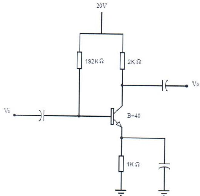
Calcule a tensão coletor-emissor ( $V_{CE}$ ), e assinale a opção correta.
