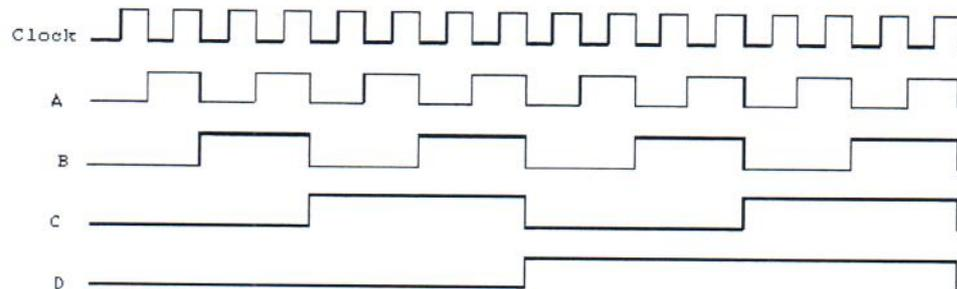
Com relação a essa figura, calcule frequência na saída C, considerando 16KHz a frequência do clock, e assinale a opção correta.
