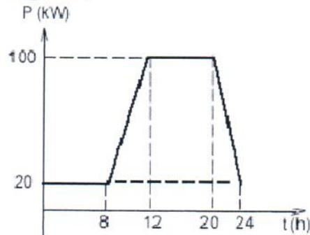
Numa fábrica, a potência  $P$  (em kW) absorvida durante um dia varia no tempo  $t$  (em h), conforme o mostrado no gráfico acima.
