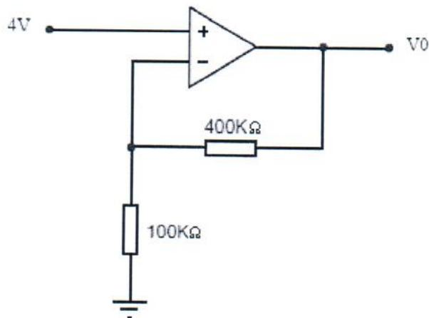
Calcule a tensão de saída ( $V_0$ ) do amplificador não-inversor representado na figura acima, e assinale a opção correta.
