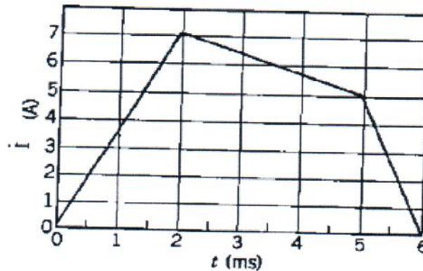
Sabendo que esse indutor possui uma indutância de  $4,6 \mu\text{H}$ , determine o módulo da tensão induzida total no indutor no intervalo  $T=0\text{ms}$  a  $t=6\text{ms}$ , e assinale a opção correta.
