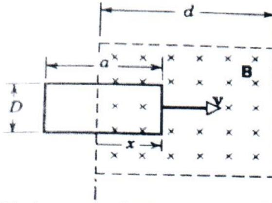
Considere que "R" é a resistência da espira acima, "D" sua largura, "a" seu comprimento e que a mesma está sendo puxada com uma velocidade constante  $v$ , através de uma região de comprimento  $d$  com um campo magnético uniforme  $B$ . Determine o módulo da força eletromotriz (fem) induzida na espira acima quando a mesma estiver totalmente imersa no campo magnético  $B$  em milivolts, e assinale a opção correta.
