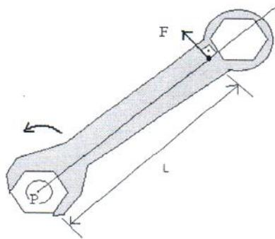
Ponto P= Ponto de contato da ferramenta com o cano da metralhadora
