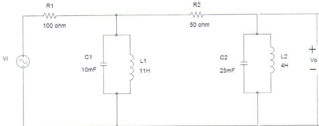
Calcule a amplitude da tensão  $V_o$  no circuito acima, para  $V_i(t) = 10 \cos(t)$ , e assinale a opção correta.
