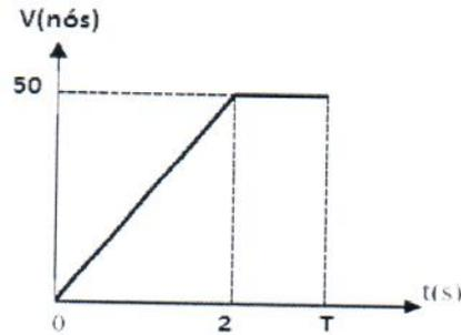
Sabe-se que um torpedo pesado, de massa 1300Kg, é lançado de um submarino submerso a 105 metros de profundidade, atingindo um valor de velocidade de cruzeiro conforme o gráfico de velocidade (em nós) versus tempo (em segundos) apresentado na figura acima. Sendo assim, assinale a opção que corresponde ao valor do impulso aplicado sobre o torpedo para que ele atinja sua velocidade de cruzeiro.
