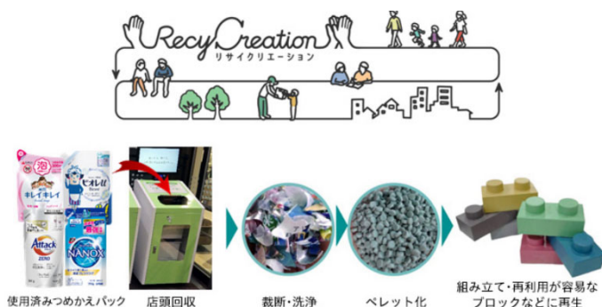
【図 32：花王・ライオン 使用済みプラスチックフィルム容器の回収・リサイクルの実証実験】
