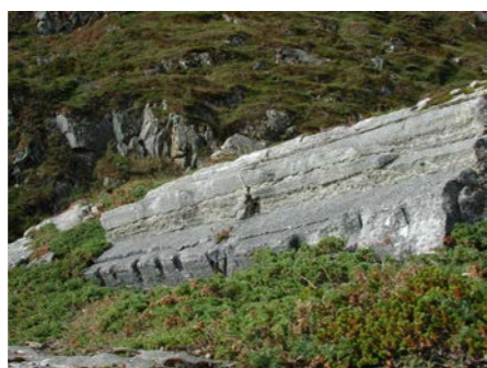
Marmorbrudd fra middelalderen på Allmenningen i Roan, kilehull for søyleproduksjon
