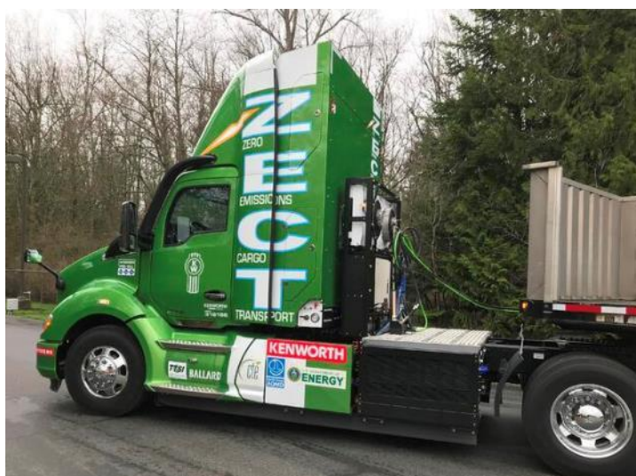
Figure 24 – Camion de factage électrique à pile à combustible (Photo offerte par Ballard Power Systems)
