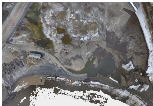
Figur 51: Området på Barryneset bærer preg av å være forstyrret av nyere anleggsaktivitet. Det er mange kjørespor fra anleggsmaskiner, samt spor etter planering og dosing av masser.
